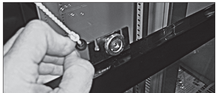
SI. 8. Gurnite crni jezičak koji drži užu za vrata van stražnje strane držača valjka.
