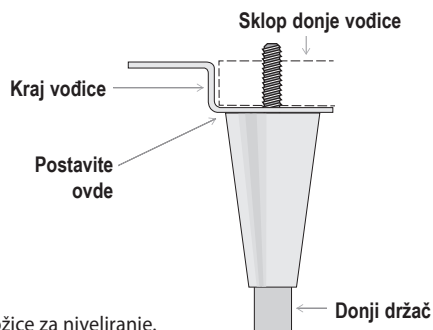
Sl. 4. Dijagram nožice za niveliranje.
