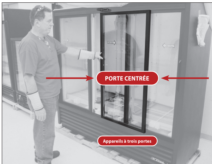
Figure 3. Centrez la porte médiane sur le bord gauche de la porte droite.
