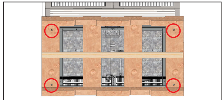
Figure 4. Emplacements des vis de transport.
