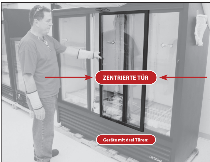
Abb. 3. Zentrieren Sie die mittlere Tür an der linken Kante der rechten Tür.
