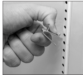
Abb. 1. Anbringen der oberen Lasche des Bodenträgers.
