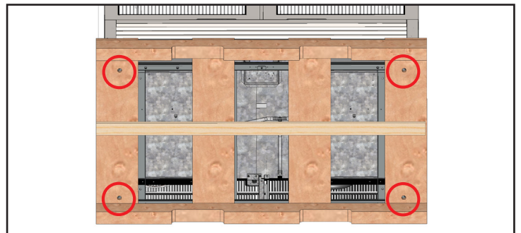
Abb. 4. Position der Transportsicherungen.
