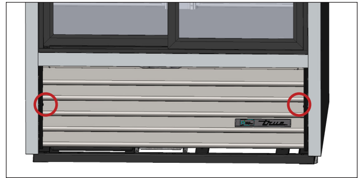
Abb. 2. Position der Schrauben am Lamellengitter der Schiebetür.
