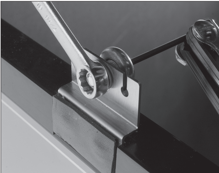
Abb. 1. Passen Sie die Rolle an.
