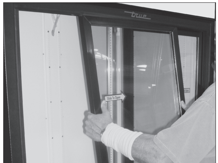
Abb. 4. Entfernen Sie die Tür vorsichtig.
