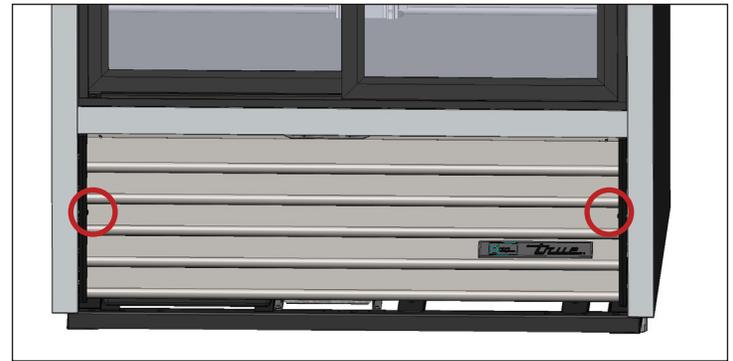
**Fig. 2** Ubicazione delle vite della griglia a persiana dello sportello scorrevole.
