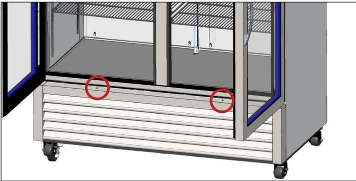
**Fig. 1** Ubicazione della vite della griglia dello sportello a battente.
