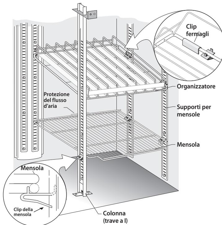
**Fig. 5** Primo piano di una mensola posta sugli appositi clip e fermagli.
