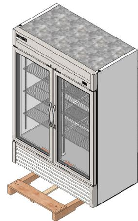
Fig. 5 Se verranno utilizzati piedi o rotelle di livellamento, ruotare l'armadietto sul pattino.
