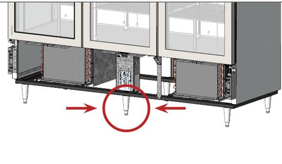
Le gambe di livellamento sono fornite per assistere nel livellamento dell'elettrodomestico. Le gambe regolabili opzionali forniranno uno spazio da 6" (152 mm) sotto l'elettrodomestico. Le rotelle orientabili forniscono mobilità all'elettrodomestico.
