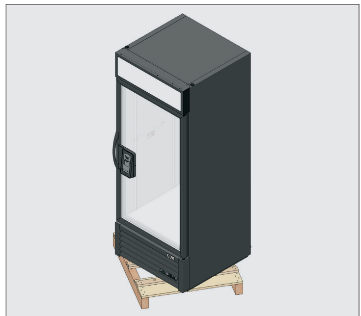
Fig. 4. Lorsque vous soulevez l'appareil, n'utilisez pas les comptoirs, les portes/tiroirs ou les grilles comme point de levage.
