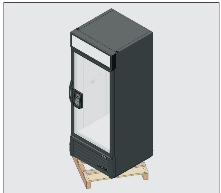
Abb. 4. Beim Anheben des Geräts nicht an den Arbeitsplatten, Türen/Schubladen oder Gittern anfassen.
