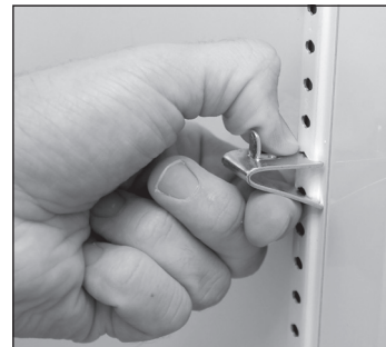
Abb. 3. Die Lasche muss zum Anbringen möglicherweise zusammengedrückt oder gedreht werden.
