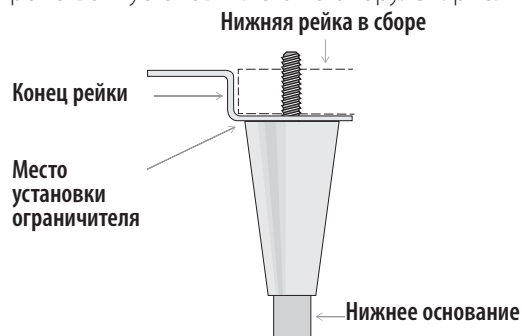
Рис. 4. Схема ножки для выравнивания.
