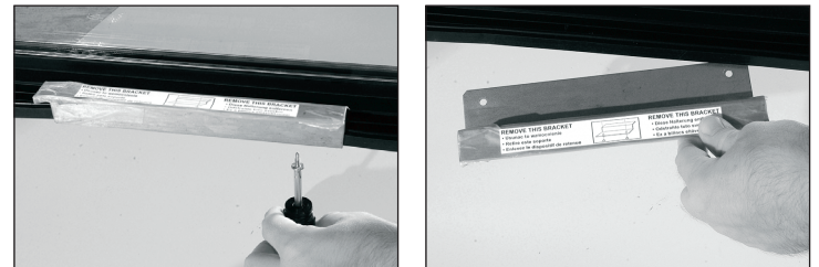
Fig. 2. Retire el soporte de transporte de la puerta de vaivén de cristal, si lo hay. No lo deseche.
