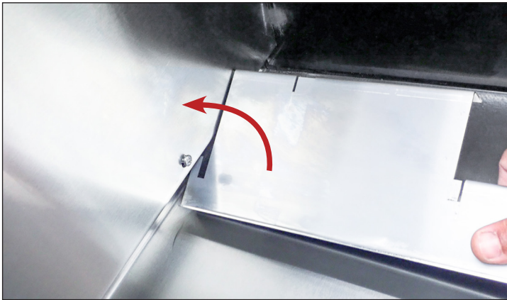
Abb. 1b. Die Träger vorsichtig bis zur Rückwand schieben.
