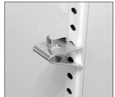
Fig. 4. Elemento de fijación instalado.
