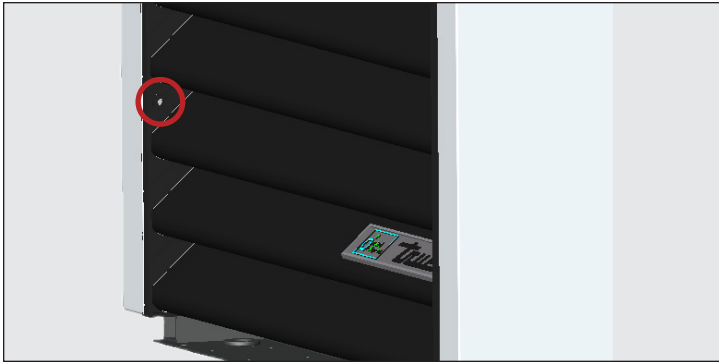
Afb. 1. Verwijder de schroeven uit de zijkanten van het rooster.
