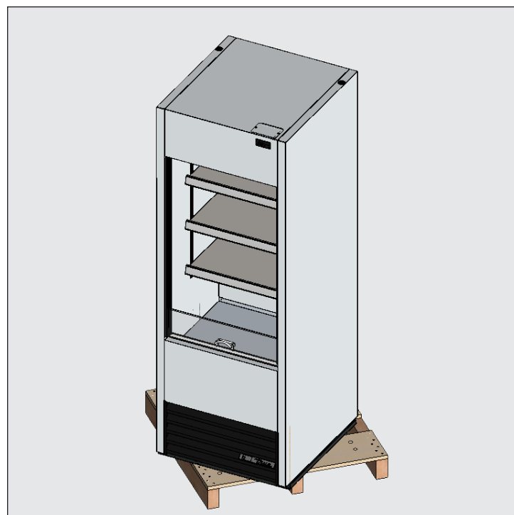
Рис. 3. Не допускается поднимать устройство, удерживая его за рабочую поверхность, дверцы, ящики и решетки.
