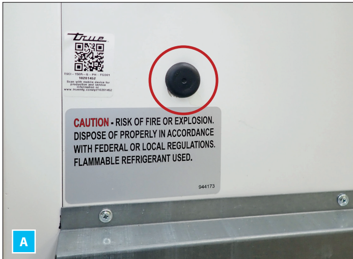
Fig. 2. Vista exterior (A) e interior (B) del puerto para sondas, modelo bajo mostrador del aparato.
