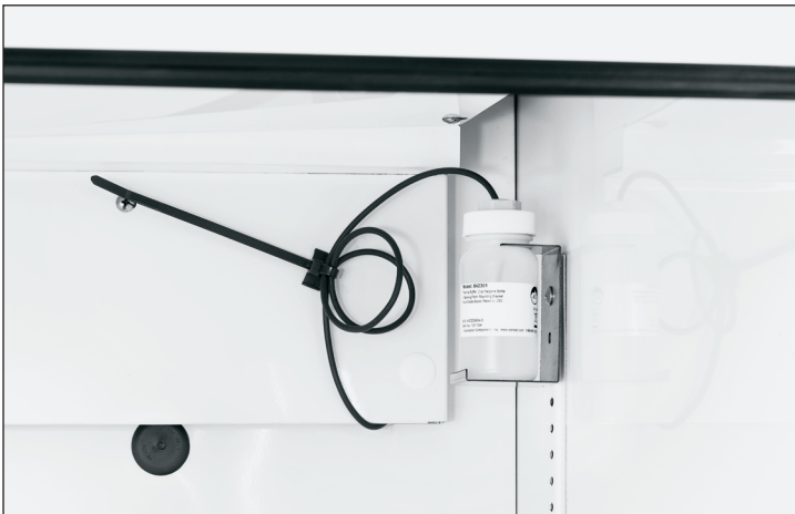
Fig. 3. TRUE recomienda instalar el conjunto de botella de glicol en el extremo superior del perfil para estantes trasero derecho , tal y como se muestra en la figura. Soporte para la botella de glicol instalado con un tornillo estándar del estante. Modelo vertical.
