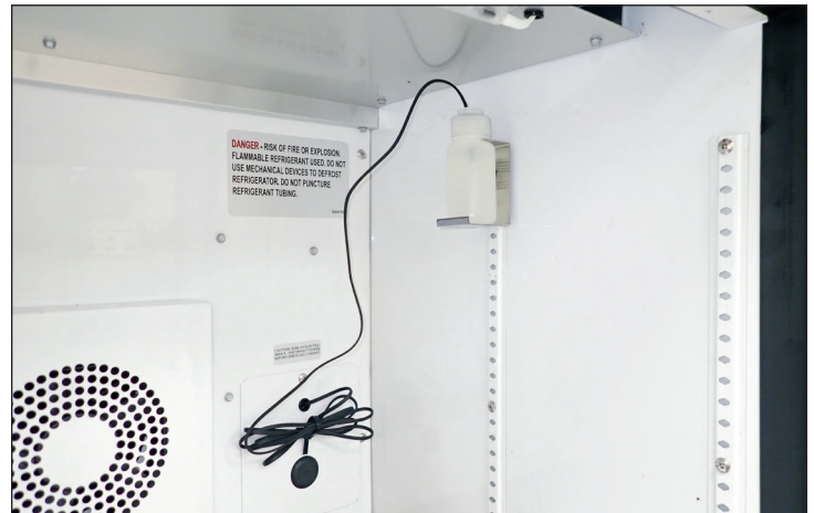
Fig. 4. TRUE recomienda instalar el conjunto de botella de glicol en el extremo superior del perfil para estantes trasero derecho , tal y como se muestra en la figura. Soporte para la botella de glicol instalado con un tornillo estándar del estante. Modelo bajo mostrador.
