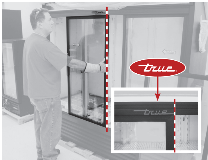
Fig. 6. Alinhe a borda direita da porta esquerda à borda direita do logotipo da TRUE.
