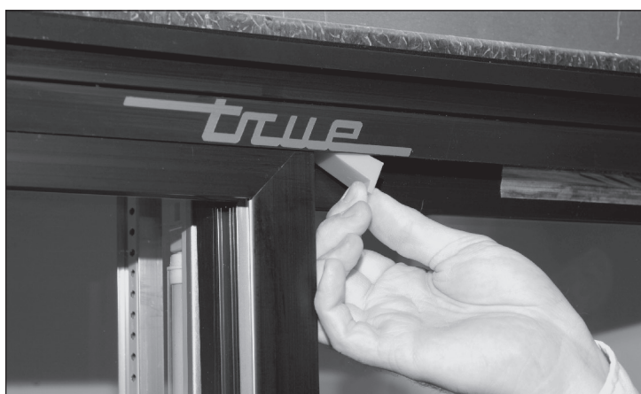
Fig. 3. Localização dos blocos de transporte das portas deslizantes de vidro. Remova, se estiverem instalados, mas não os descarte.
