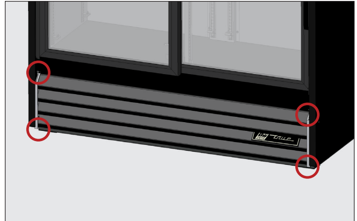
Fig. 2. Localização do parafuso da grelha no modelo com portas deslizantes.
