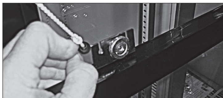
Fig. 8. Deslize a aba preta segurando o cabo da porta para fora da parte de trás do suporte do rolete.
