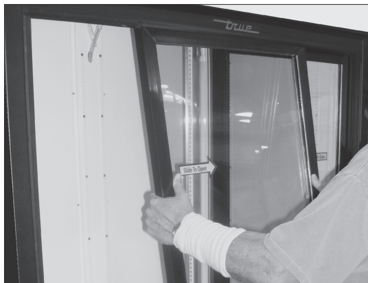
Рис. 4. Осторожно снять дверцу.
