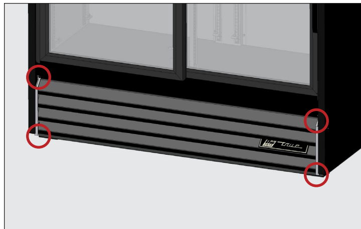
Рис. 2. Винты крепления жалюзийной решетки под раздвижными дверцами
