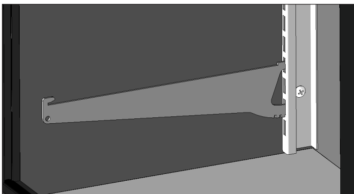
Рис. 4. Установлен опорный кронштейн полки.
