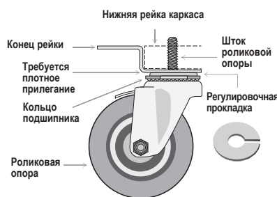
Рис. 7. Схема роликовой опоры.
