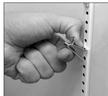
Рис. 2. Нижняя часть кронштейна должна зафиксироваться.
