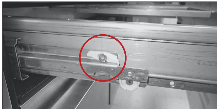
Рис. 1. Местонахождение фиксатора ящика. Фиксатор введен в зацепление.
