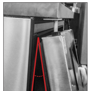
Рис. 10. При установке дверцы угол между дверцей и корпусом устройства должен быть небольшим.
