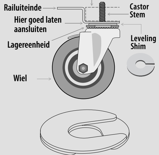
Afb. 4. Wiel met stang en onderlegplaatjes. Installeer meerdere onderlegplaatjes met verspringende sleuven.
