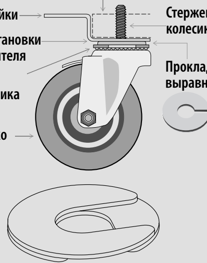
Рис. 4. Колесико и прокладки для основания. Монтируйте несколько прокладок со смещением отверстий.
