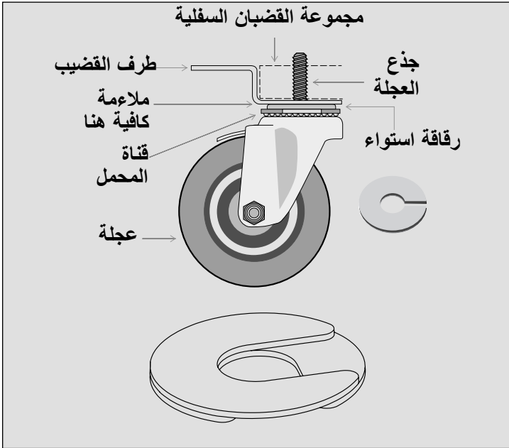
الشكل ٤. عجلة ورقاقات حشو الجذع. ركب رقائق حشو متعددة بفتحات إزاحة.
