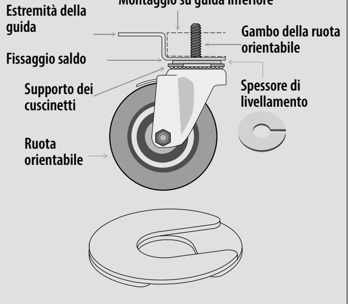
Fig. 4. Gambo ruote orientabili e spessori. Installare più spessori con le fessure di compensazione.
