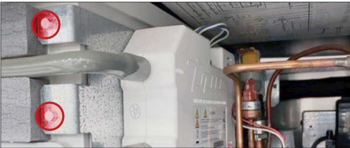
الشكل 3. عرض جانبي لنظام TrueZone للأشعة فوق البنفسجية. أماكن براغي حامل TrueZone.
