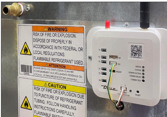
Рис. 2. Провода подключены к модему. Зеленый/желтый – к клемме TEC; коричневый/белый – к клемме POWER.
