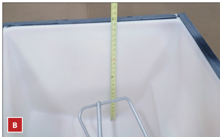
Рис. 2. Перед установкой льдогенератора обязательно измерить глубину контейнера (A) или диспенсера (B) для настройки датчика уровня льда.
