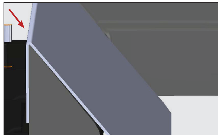
Рис. 4. Установлен дефлектор зоны выдачи льда, вид сбоку.
