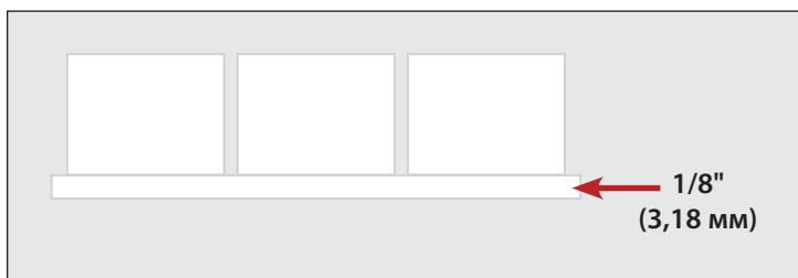
Рис. 1. Ледяная перемычка удерживает кубики льда вместе.
