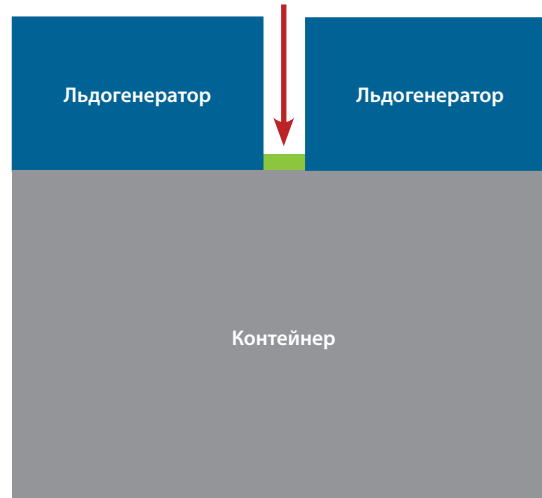
Рис. 2. Льдогенераторы установлены с обеих сторон бункера.
