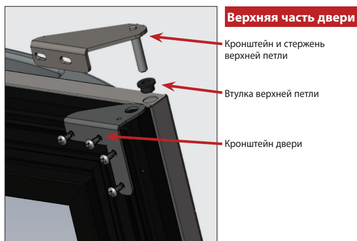
Рис. 4а. Компоненты верхней петли.
