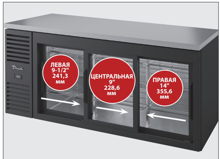
Рис. 4. Устройства с тремя дверьми: Для извлечения дверей из направляющей переместите их, как указано.
