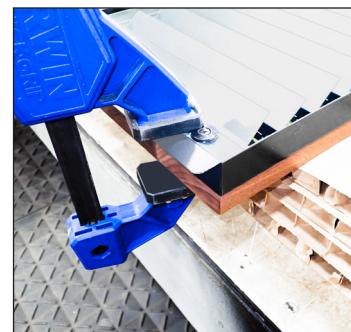
Рис. 2. Выровняйте накладку и решетку по углам. Панель немного больше решетки.
