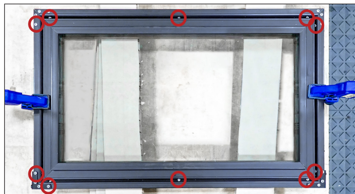
Рис. 7. Расположение предварительно просверленных отверстий двери шкафа.
