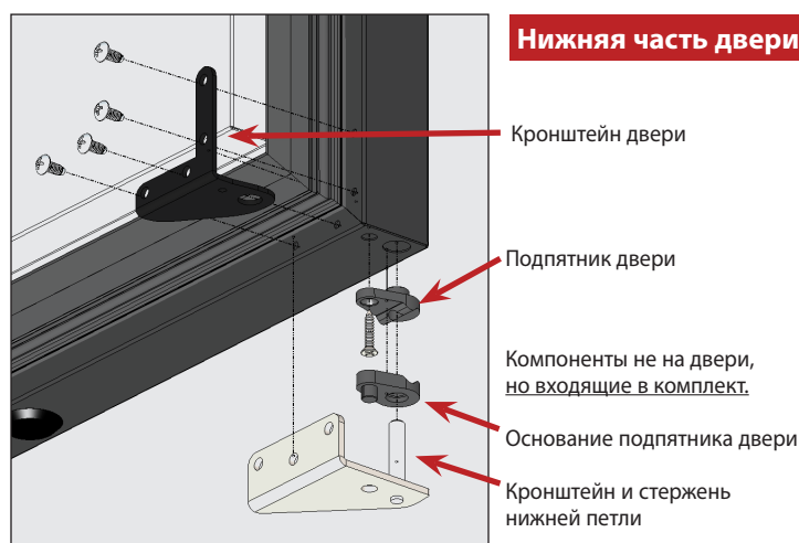
Рис. 4б. Компоненты нижней петли.
